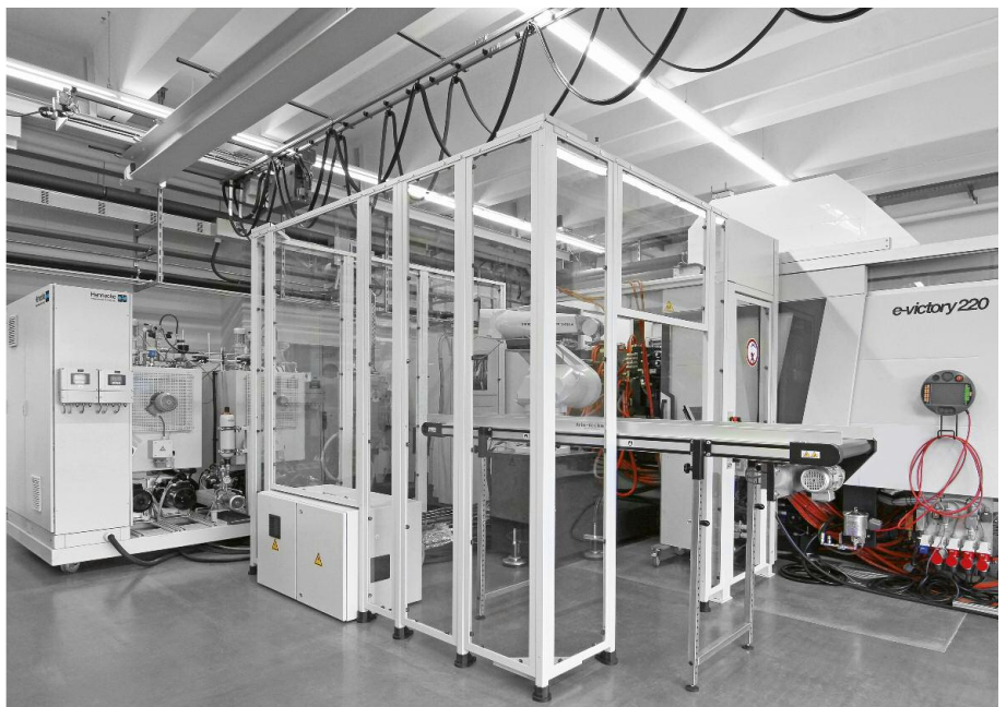
Produktionszelle mit einer Spritzgussanlage und integrierter STREAMLINE-Dosiermaschine zur Herstellung von clearmelt®-Bauteilen Production cell with injection moulding unit and integrated STREAMLINE metering machine for the manufacturing of clearmelt® components
