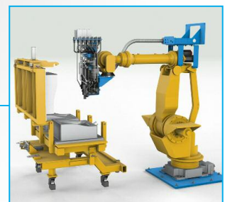
Roboter-gesteuerte Eintragsstation Robot-controlled pouring station
