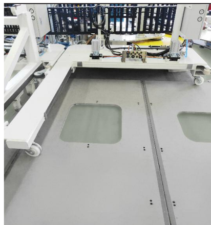
Wechsel der Formenträger bei Bandgeschwindigkeiten von bis zu 15m/min: das Easy-Connect-Disconnect-System (ECD) Exchange of mould carriers at conveyor speeds of up to 15m/min: the Easy-Connect-Disconnect system (ECD)
