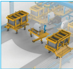
Automatische Ein- und Aus- schleusestation für Formen- träger-Wagen (ECD)
